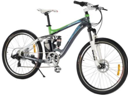
Vélo électrique pour randonnée et montagne avec moteur 250W et batterie lithium 36V 6Ah.
